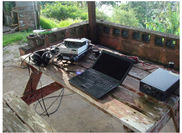
Una de las estaciones: FT-857, Interface Rigblaster y SCS-PTC-II.
