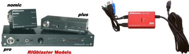
La gran ventaja de estas interfaces es que soportan el control del radio, o *CAT*; esto permite que el log de concurso esté sincronizado con el radio, de tal manera que (por ejemplo) si usted sintoniza el radio en la frecuencia 14.083 Mhz. el log registrará esa frecuencia y modo de operación actual. Al cambiar de frecuencia, el log se actualizará en tiempo real. Obviamente el radio deberá tener soporte de *CAT* para que se lleve a cabo dicha comunicación.
